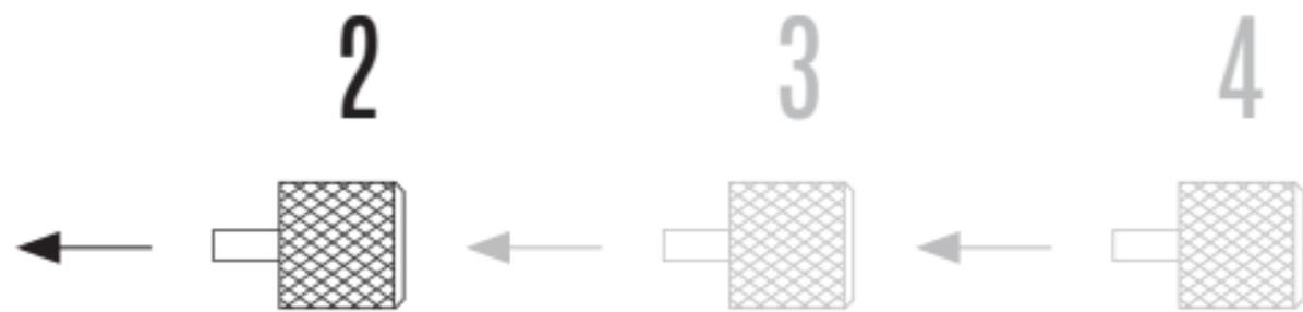
*La couronne doit être vissée en position 1 pour garantir que la montre est étanche.*
